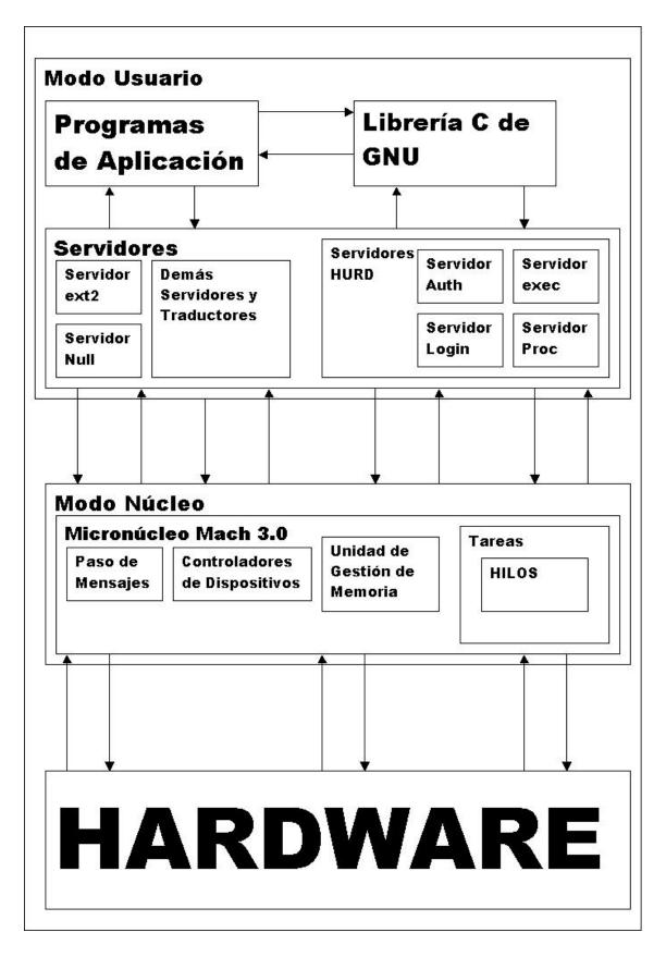
La idea de este nuevo modelo es separar partes que estaban dentro del núcleo, sacarlas y ponerlas en el espacio del usuario, por ejemplo el sistema de ficheros. Por otra parte debido a la complejidad que suponía un servidor de gestión de memoria y de acceso a hardware, (una especie de servidor drivers que controlara la entrada/salida y interrupciones) era bastante costoso implementarlo así que se metió en el núcleo.
