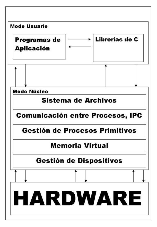
La imagen anterior muestra un núcleo monolítico por capas, la representación es muy básica, aunque vamos a comentar los aspectos que nos atañen. Normalmente en Unix se diferencian dos capas principales las que dependen del Hardware las que no. Entre las que dependen del hardware se encuentran:
